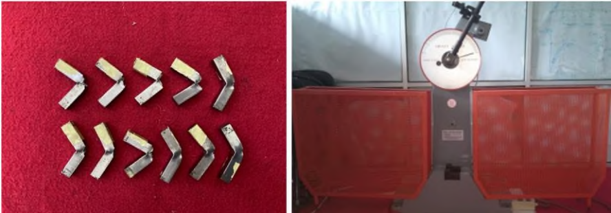
Gambar 5. Hasil pengujian impak dan Alat uji Impak
