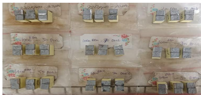
Gambar 4 Hasil Patahan Setelah Pengujian Impak
