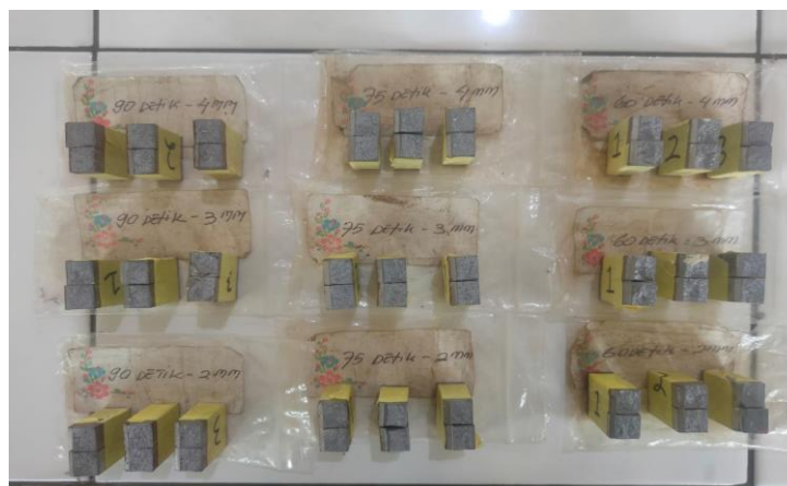
Gambar 4. Hasil Patahan Dari Pengujian Impak Charpy
