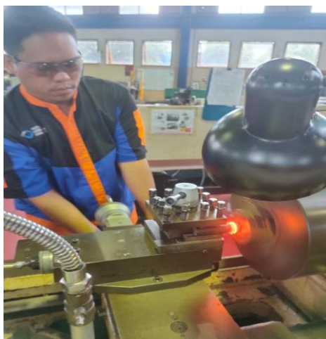
Gambar 1. Proses Las Gesek Dengan Mesin Bubut
