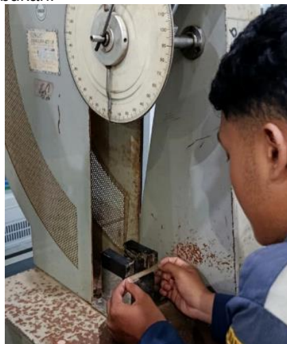
Gambar 4. Penempatan Spesimen Pada Mesin Uji Impak Charpy
