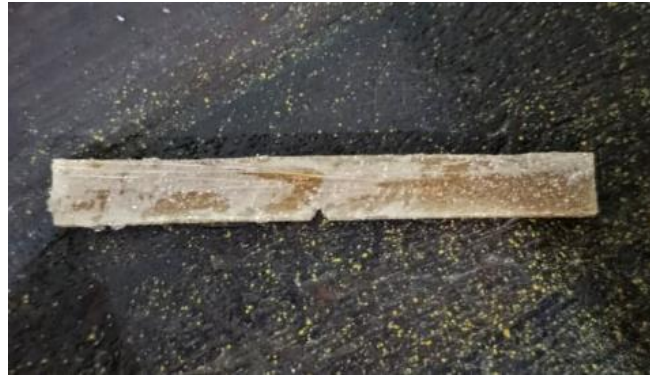
Gambar 3. Spesimen komposit yang digunakan pada pengujian impak
