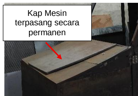
Gambar 8. Kondisi Kap Mesin sebelum Modifikasi
