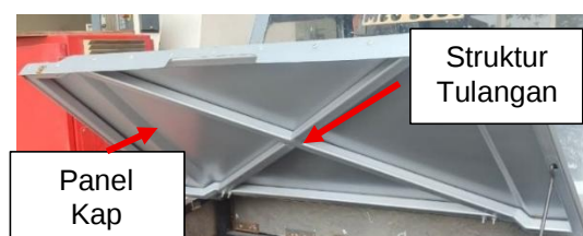
Gambar 7. Panel Kap Mesin Setelah Dipasang Rangka Tulangan
