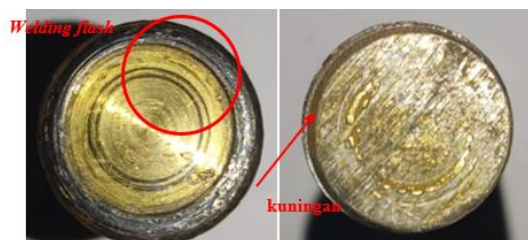
Gambar 10. Hasil Pengelasan tanpa Free Heat dengan Variasi Waktu 8 menit
