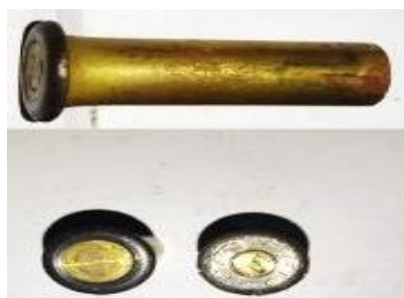
Gambar 14. Kuningan Setelah Proses Pengelasan Gesek
