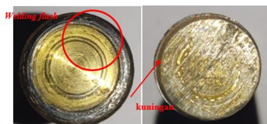
Gambar 9. Hasil Pengelasan dengan Free Heat dengan Variasi Waktu 7 menit
