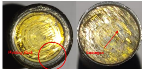
Gambar 6. Hasil Pengelasan tanpa Free Heat Variasi Waktu 6 menit
