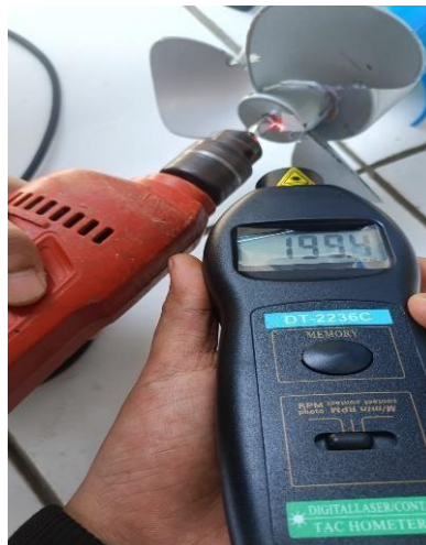
Gambar 4. Pengujian Infrared Speed Sensor LM 393 yang dibandingkan dengan Tachometer
