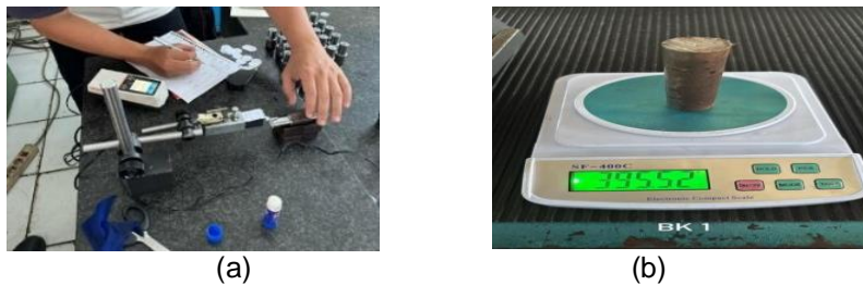
Gambar 3. Proses pengambilan data kekasaran (a) dan proses pengambilan data MRR (b)
