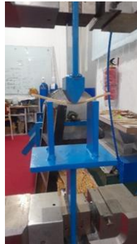
Gambar 1. Pengujian Bending Menggunakan Mesin Zwick Roell Z20
