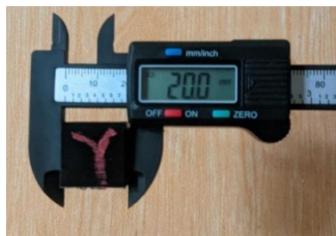
Gambar 11. Pengukuran Sumbu Y
