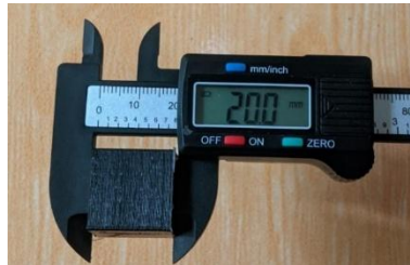
Gambar 9. Pengukuran Sumbu Z (Tinggi)
