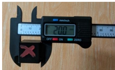
Gambar 10. Pengukuran Sumbu X
