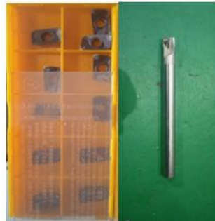
Gambar 2. Insert Carbide dan Holder
