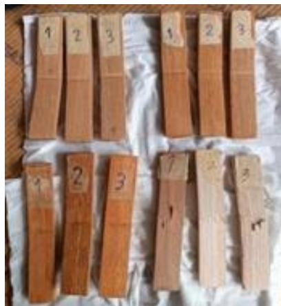
Gambar 3. Sampel setelah mengalami perendaman
