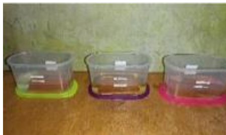
Gambar 2. Perendaman komposit laminasi dengan media cair.
