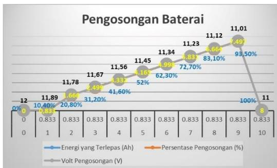
Gambar 10. Pengujian Pengosongan Baterai
