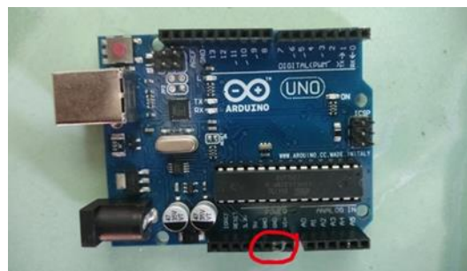
Gambar 5. Kerusakan Arduino Uno
