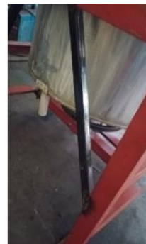
Gambar 4. Penambahan Batang Logam pada Kerangka Mesin
