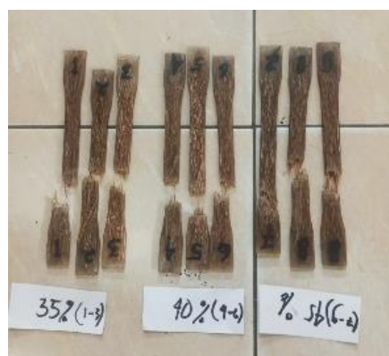
Gambar 5. Patahan Sampel Pengujian
