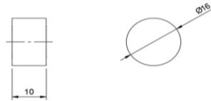
Gambar 3. Dimensi Spesimen Uji Kekerasan.
