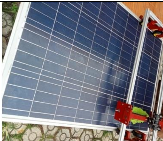
Gambar 11. Pengujian Robot Pembersih pada Panel Surya
