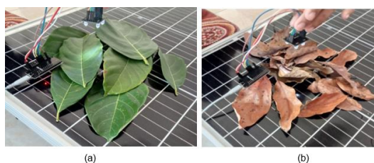
Gambar 10. Pengujian Sensor pada Objek Daun Hijau (a) dan Daun Kering (b)
