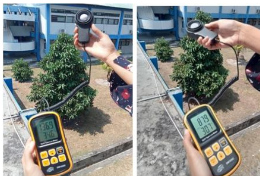
Gambar 12. Pengambilan Data pada Intensitas Matahari Menggunakan Lux Meter
