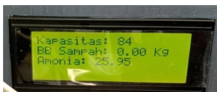
Gambar 9. Pengujian LCD 20 X 4 12C
