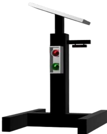
Gambar 5. Desain Kontruksi Tiang Traffic Light Portable
