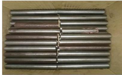
Gambar 3. Benda Uji Baja ST-41 1 ggg
