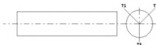
Gambar 5. Titik Pengujian Kekasaran Benda Kerja
