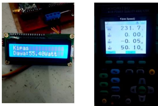
Gambar 7. Perbandingan Pengukuran Daya Antara PZEM-004T dan Power Quality Analyzer Pada Kipas Angin Dengan Kecepatan Level 2.
