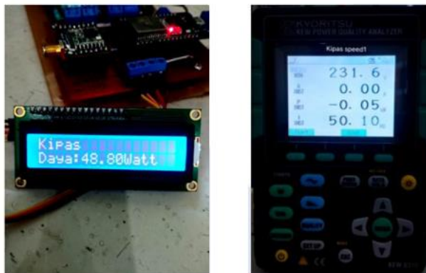
Gambar 6. Perbandingan Pengukuran Daya Antara PZEM-004T dan Power Quality Analyzer Pada Kipas Angin Dengan Kecepatan Level 1.
