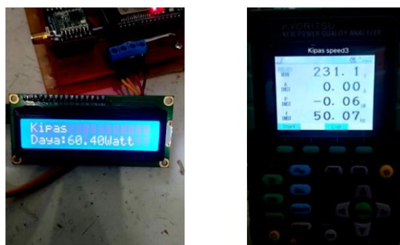
Gambar 8. Perbandingan Pengukuran Daya Antara PZEM-004T dan Power Quality Analyzer Pada Kipas Angin Dengan Kecepatan Level 3.
