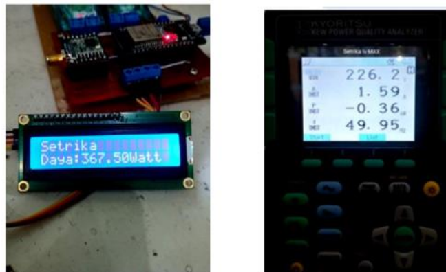
Gambar 9. Perbandingan Pembacaan Daya Menggunakan PZEM-004T dan Power Quality Analyzer Pada Setrika
