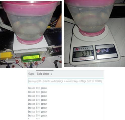
Gambar 6. Pengujian sensor load cell
