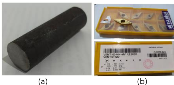
Gambar 1. a) Baja SKD 11 b) Pahat Carbide
