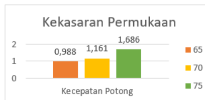
Gambar 6. Kekasaran Permukaan Berdasarkan Kecepatan Potong
