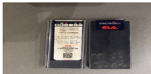
Gambar 3. Mata Potong Insert Carbide
