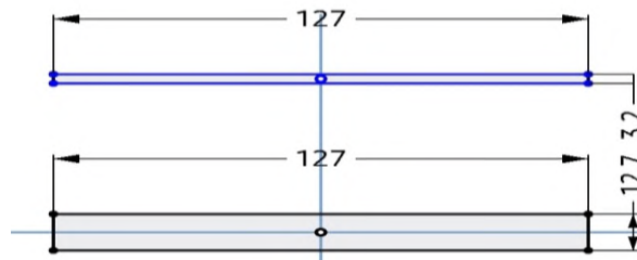
Gambar 1. Bentuk dan Ukuran Spesimen ASTM D-790
